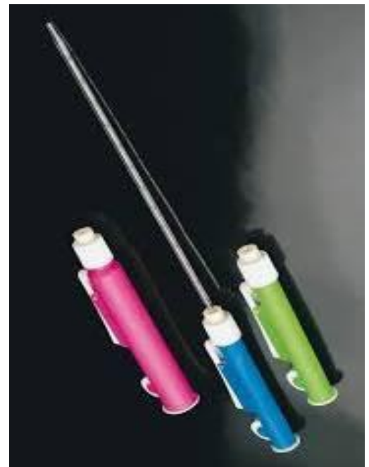
სურათი 4. 84. პიპეტებში ნივთიერების ამოსატუმბი მოწყობილობა
