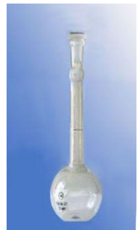
ა) ბ) სურათი 4. 56. პიკნომეტრით სიმკვრივის განსაზღვრა
