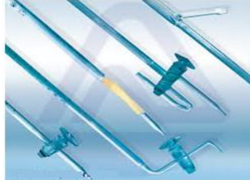
სურათი 4. 79. ონკანიანი და უონკანო ბიურეტები
