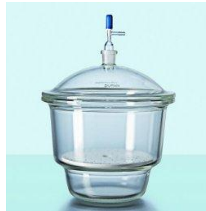
სურათი 4. 68. ექსიკატორები: ა) უონკანო; ბ) ონკანიანი
