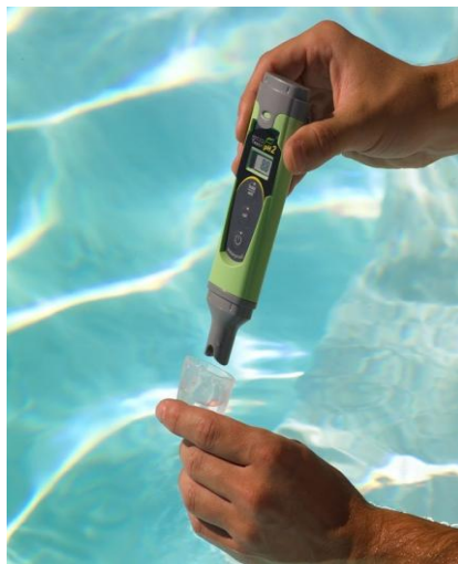
სურათი 4. 76. გაზომვა pH-მეტრის „Checker“ – HI 98103 საშუალებით
