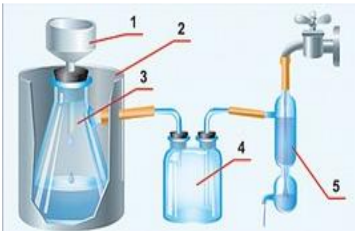
სურათი 4. 97. ვაკუუმ-ფილტრაციის მოწყობილობა. 1. ბიუნზერის ძაბრი; 2. დამცავი გარსაცმი; 3. ბუნზენის კოლბა; 4. დამცავი ჭურჭელი; 5. წყალჭავლური ტუმბო
