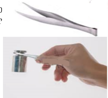
სურათი 4. 62. წვრილსაწონის პინცეტით დაჭერა
