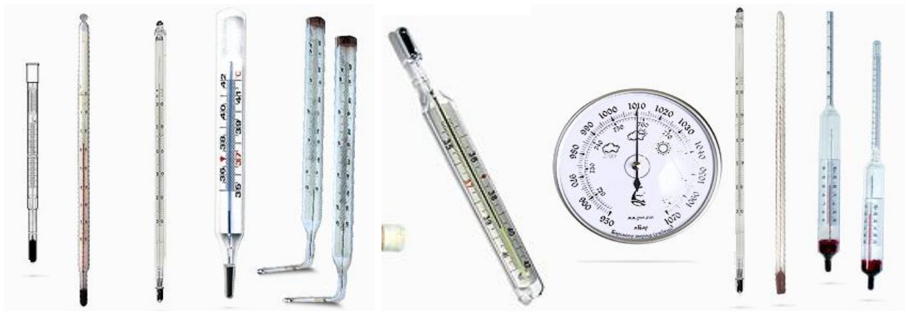
ვერცხლისწყლის (Hg) შემცველი მინის თერმომეტრები. ლაბორატორიული თერმომეტრები T1, ტექნიკური TTY -- შეიცავს 5-10% Hg-ს; სამედიცინო თერმომეტრები TM -- შეიცავს 15-20% Hg-ს.
