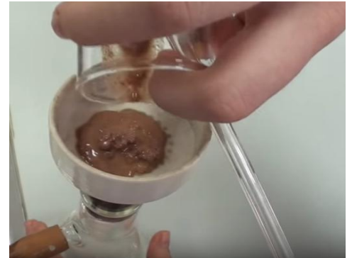
სურათი 4. 96. გასაფილტრი ნარევის გადატანა ფილტრზე.
