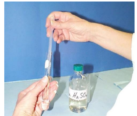
სურათი 4. 69. გოგირდმჟავას სიმკვრივის დადგენა
