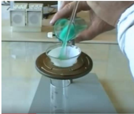
სურათი 4. 94. ნალექის გაფილტვრა. 1. შტატივი; 2. მომჭერი; 3. გასაფილტრი ნარევი; 4. ძაბრი; 5. ფილტრატი
