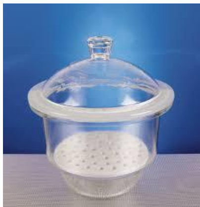
სურათი 4. 68. ექსიკატორები: ა) უონკანო; ბ) ონკანიანი
