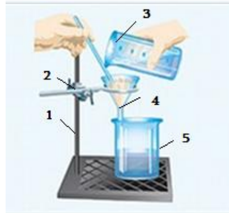
სურათი 4. 94. ნალექის გაფილტვრა. 1. შტატივი; 2. მომჭერი; 3. გასაფილტრი ნარევი; 4. ძაბრი; 5. ფილტრატი
