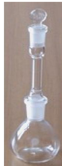
ა) ბ) სურათი 4. 56. პიკნომეტრით სიმკვრივის განსაზღვრა
