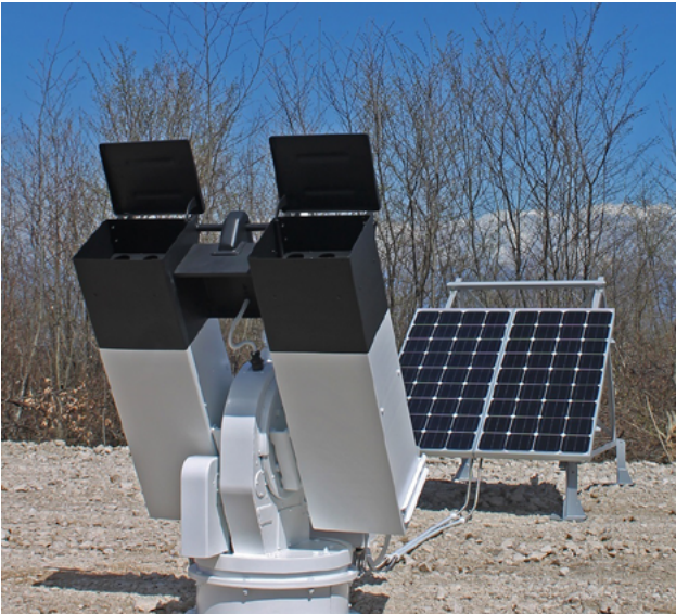
სურათი 4.3.5 სეტყვის საწინააღმდეგო სარაკეტო გამშვები განთავსებულია სპეციალურად შემოღობილ ტერიტორიაზე, მისი კვება ავტონომიურია და მზის პანელით ხდება.
