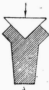
ნახ. 112. სოლის შეჭრის პროცესის სქემა: ა—ბლაგვეკუთხიანი ძელაკი; ბ—მახვილკუთხიანი ძელაკი.
