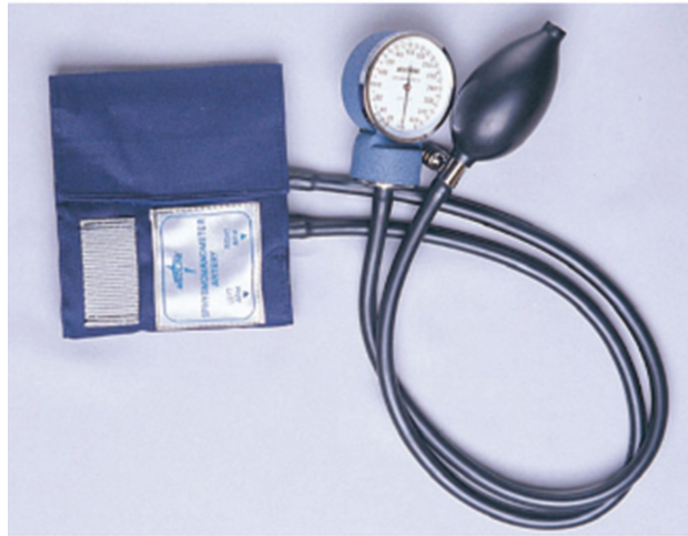
სურათი 12.6 40 წნევის საზომი მოწყობილობა, ანეროიდული მანომეტრი და მანუეტი
