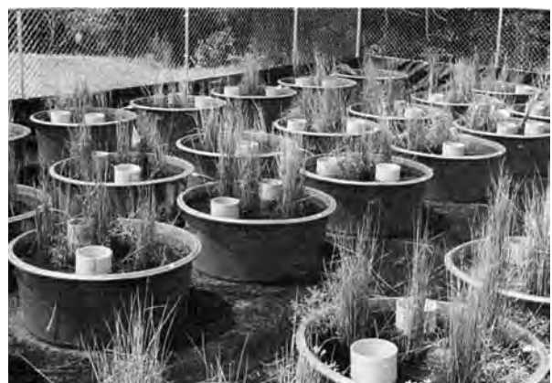
სურ. 2-7 ექსპერიმენტული დაწესებულება ფიელდ სტეიტონის მისისიპის უნივერსიტეტში. ექსპერიმენტები ხორციელდება ცალკეულ რეზერვუარებში. რადგანაც თითოეული რეზერვუარი ერთი და იგივე წყლის წყაროს იყენებს და ერთსა და იმავე გარემო პირობებშია მოთავსებული, ისინი განსხვავდებიან მხოლოდ ექსპერიმენტატორის მიერ განხორციელებული მოპყრობით. (ს.ტ. თრეკლედმა მოგვანოდა)
